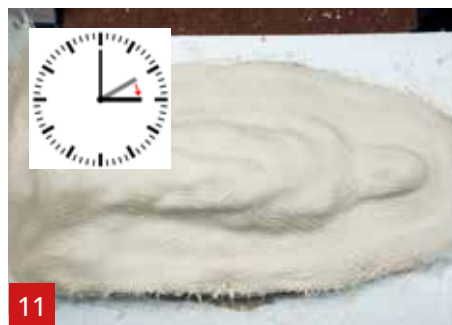
11 Пусть опорная форма A1 высохнет в течение 60 минут.
