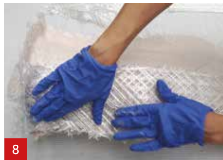
8 ... и нанесите второй слой трехосного волокна A1 на еще влажный A1.
