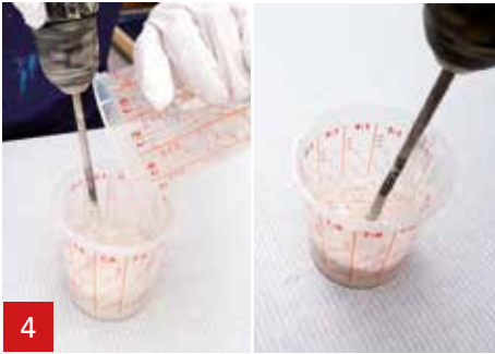
4 Аккуратно добавьте порошок A1 в жидкость A1. Перемешать миксером, пока все комки исчезли ( \pm 1 мин.), в результате получается гладкий материал.
