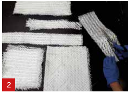
2 Разрежьте трехосное волокно A1 на различные размеры, достаточно для 4 слоев.
