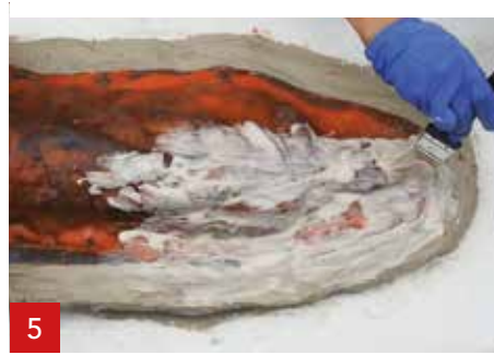
5 Нанести A1 с кистью на силиконовую форму.
