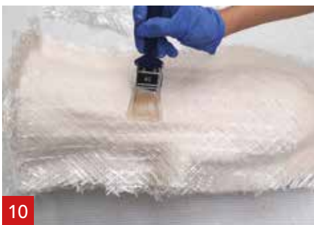
10 Смазать этот слой снова с A1. Повторяйте, пока не нанесете 4 слоя трехосного волокна A1.
