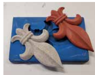
Результат после сушки и выгрузки - сплошной литой объект, точная копия формы.
