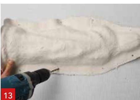
13 При необходимости, можно просверлить отверстия в A1 поддержки формы, чтобы поставить болты и гайки.
