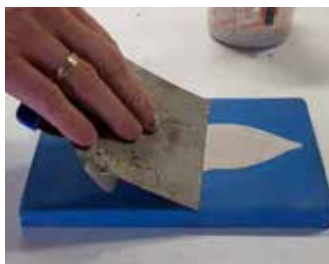
Вылейте желаемое количество А1 в форму и разгладьте излишки А1 шпателем.
