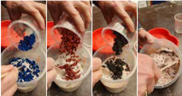
Добавьте разные цвета битого А1 к смешанному А1 и хорошо перемешайте.
