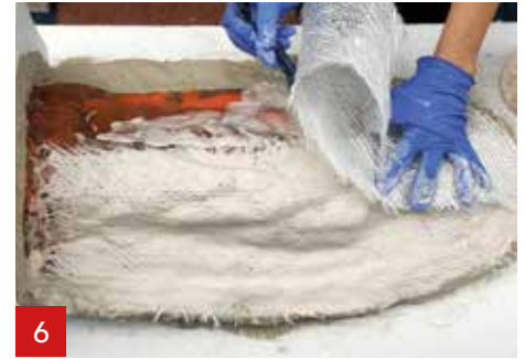
6 Положите трехосное волокно A1 на мокрое A1. Продолжайте, пока вся силиконовая форма не будет покрыта A1 и слоем трехосного волокна A1.
