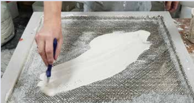
Чтобы ламинировать, нужно работать мокрым по мокрому. Быстрый способ нанесения A1 - с помощью кисти или валика.
