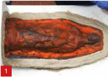
1 Стабилизируйте силиконовые формы перед сделать первую стороне опорной формы.
