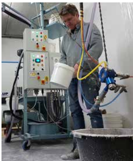
Опрыскивание с нарезанными волокнами
